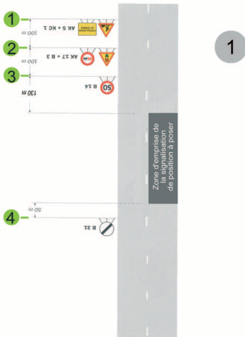
Phase 1 : Pose de la signalisation du côté opposé aux travaux
