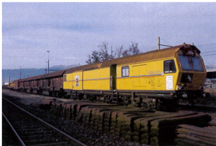
Train meuleur de rails (Scheuchzer S.A.)
