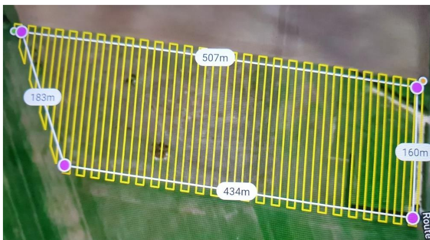
Figure 31 : Plan de vol du drone DJI P4 RTK
