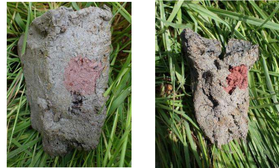
Photo 3 : Exemple du précipité rouge de la réaction du test à la phénanthroline
